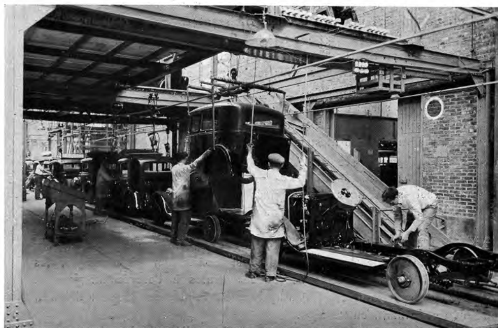
Carrosserie Montage d'une caisse sur le châssis
