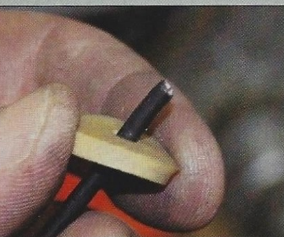
Introduire l'autre extrémité du fil de connexion à travers la rondelle d'étanchéité.
