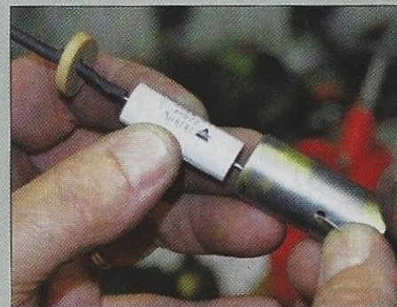
26 L'introduire dans le corps jusqu'à faire ressortir le fil par le petit trou.
