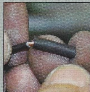
37 Equiper cette extrémité d'une gaine thermorétractable.
