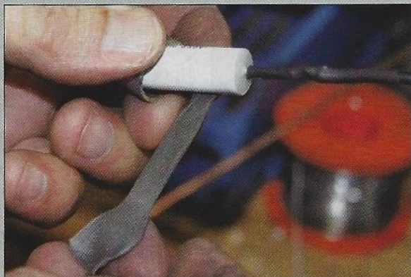
Introduire l'autre extrémité du fil de connexion à travers la rondelle d'étanchéité.
