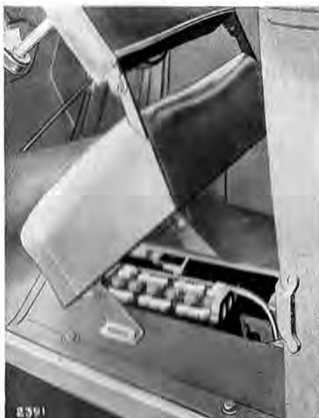
Fig. 96. — Accessibilité aux accumulateurs :
