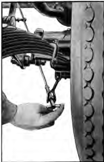
Fig. 16. — Réglage du frein arrière.
