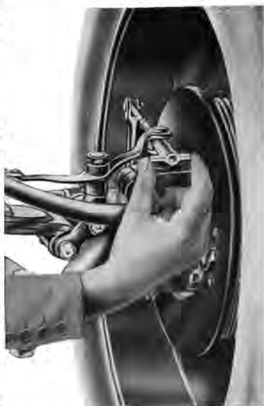
Fig. 15. — Réglage des freins avant.
