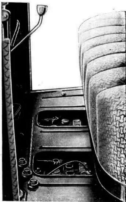
Fig. 29 — Vue montrant la facilité d'accès aux accumulateurs. On aperçoit sur le plancher les 5 bouchons démontés pour vérifier le niveau de l'électrolyte.
