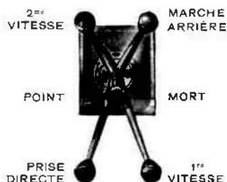
Fig. 35. — Schéma des positions du levier de vitesses.
