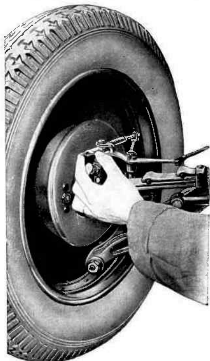
Fig. 22. - Réglage des freins avant.
