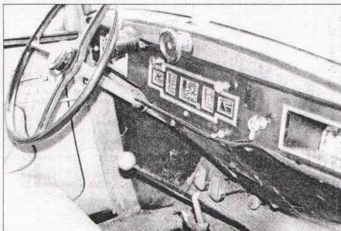
La planche de bord est succincte mais son instrumentation assez complète. Notez le carénage inférieur en carton-pâte.
