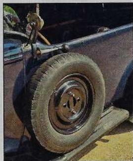
Cette carrosserie étant dépourvue de porte gauche, la roue de secours a été disposée à cet endroit. Remarquez l'usure du marchepied qui a beaucoup servi, certainement pour enjamber le flanc afin d'entrer par ce côté.
