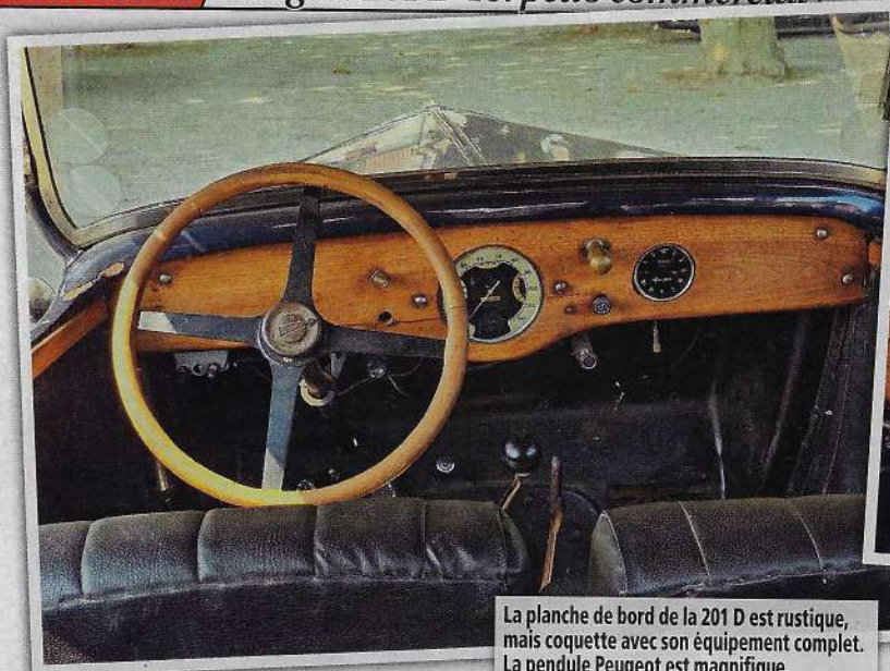
Pression d'huile, charge, niveau d'essence et vitesse : le combiné O.S. est joli et complet. Si l'auto est capable d'atteindre 85 km/h, il est raisonnable de s'en tenir à 65-70 km/h.
