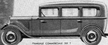
FAMILIALE COMMERCIALE 201 T 6 places face route. 2 vitres avant, 4 portes. Banquette AJL et faux planches amovibles. Emplacement pour le transport : long 1 m 45, large 1 m 30, haut 1 mètre. Double hayon arrière. Pare-brise de sécurité. (Voir caractéristiques communes à toutes les 201 T.)
