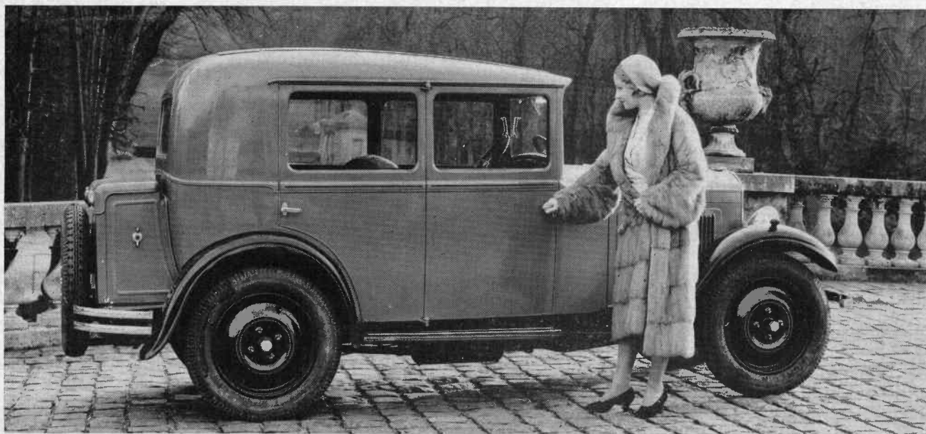
La berline « 201 » luxe, troisième version, contemporaine de la « 201 C » : malle Coquille, pare-chocs à lames (simple à l'avant, doubles à l'arrière) mais pas d'enjoliveurs de roues. La version « série » conserve le toit simili et l'ancienne malle
