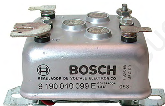
Branchement régulateur électronique Bosch à excitation négative sur Peugeot 201 Borne 61 non utilisée ( sortie négative vers lampe témoin de charge optionnelle)
