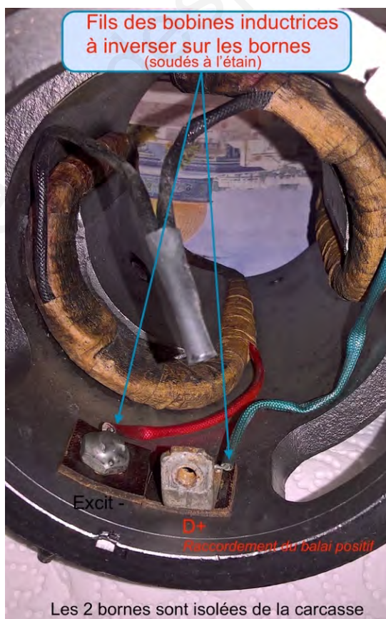
Inversion des fils dans la dynamo
